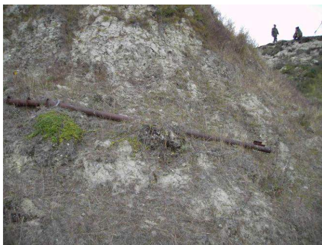
Рисунок 2. Выпучивание грунтовых трубчатых реперов (тип 150 оп. знак) на территории Бованенковского газоконденсатного месторождения
