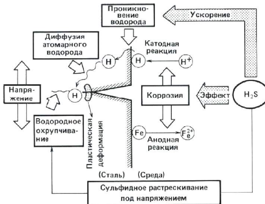
Рис. 1. — Схема процесса сероводородного растрескивания.
