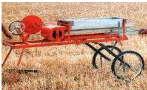
Рисунок 3. Сепаратор РМ-228 для выделения потерь зерна в рабочем положении
