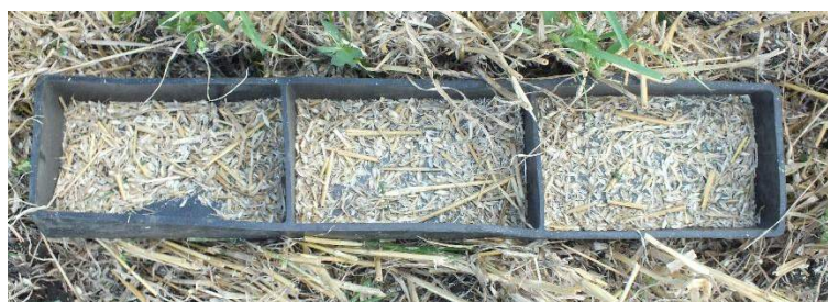
Рисунок 1. Пробоотборник потерь зерна, установленный в междурядье озимой пшеницы
