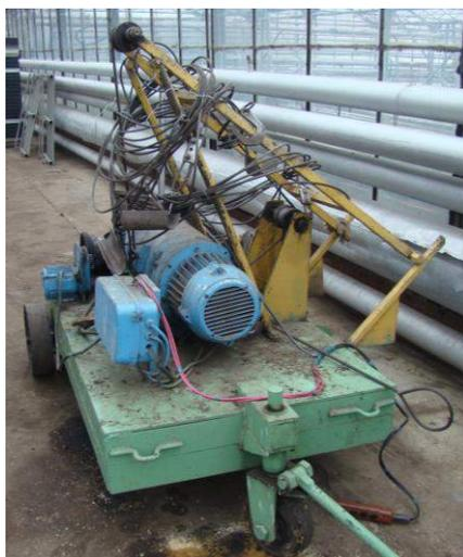
Рисунок 3. Опытный образец машины для подъёма тепловых регистров
