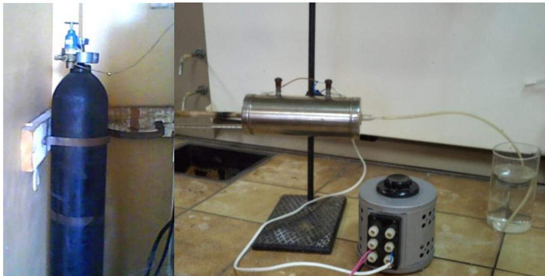
Рисунок 2. Установка для термической обработки сорбентов
