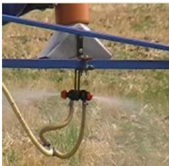
Рисунок 3 Общий вид функционирования пневмогидравлического устройства в составе экспериментального образца опрыскивателя.
